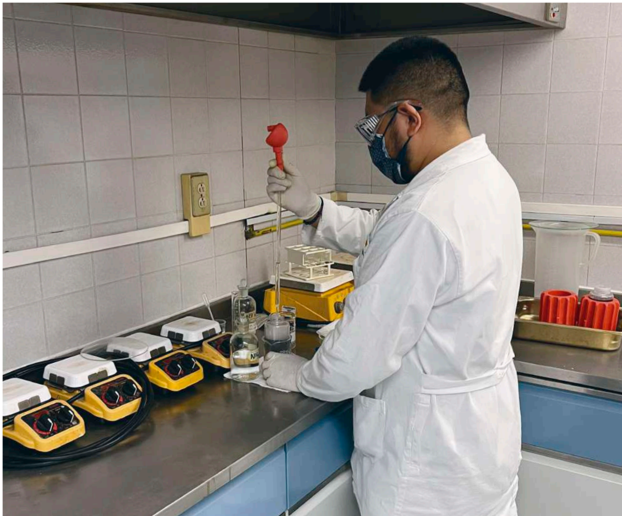
Fotografía 30. Tratamiento de una muestra proveniente de los alrededores de la Central Nucleoeléctrica Laguna Verde para determinar la concentración de estroncio. Comisión Nacional de Seguridad Nuclear y Salvaguardias.
