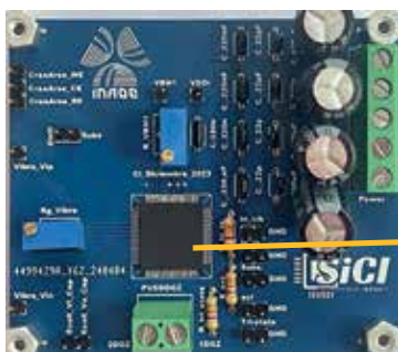
Sensor electroquímico para la detección de creatinina
